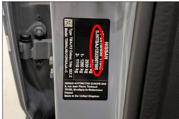
VIN au niveau du montant B, côté conducteur
