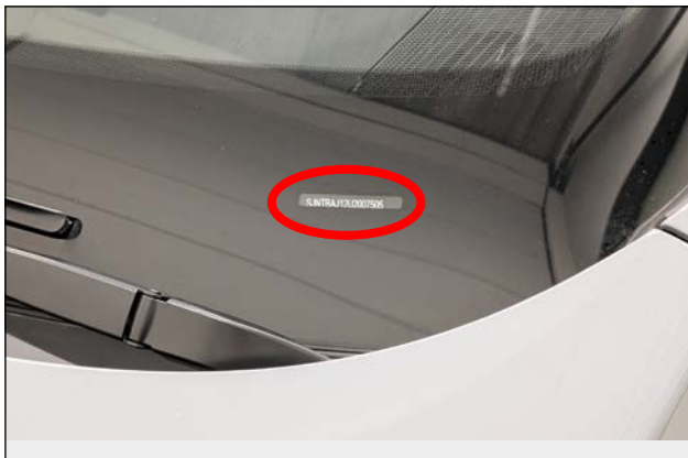
VIN dans la partie inférieure gauche du pare-brise avant
