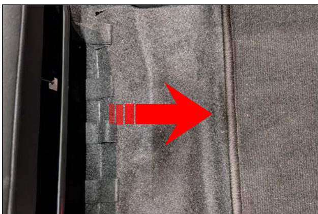
VIN estampillé sous le siège avant droit, sur le châssis, sous la housse
